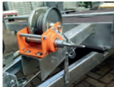
Fig. Mulighed: Spil + kabel + støtte
